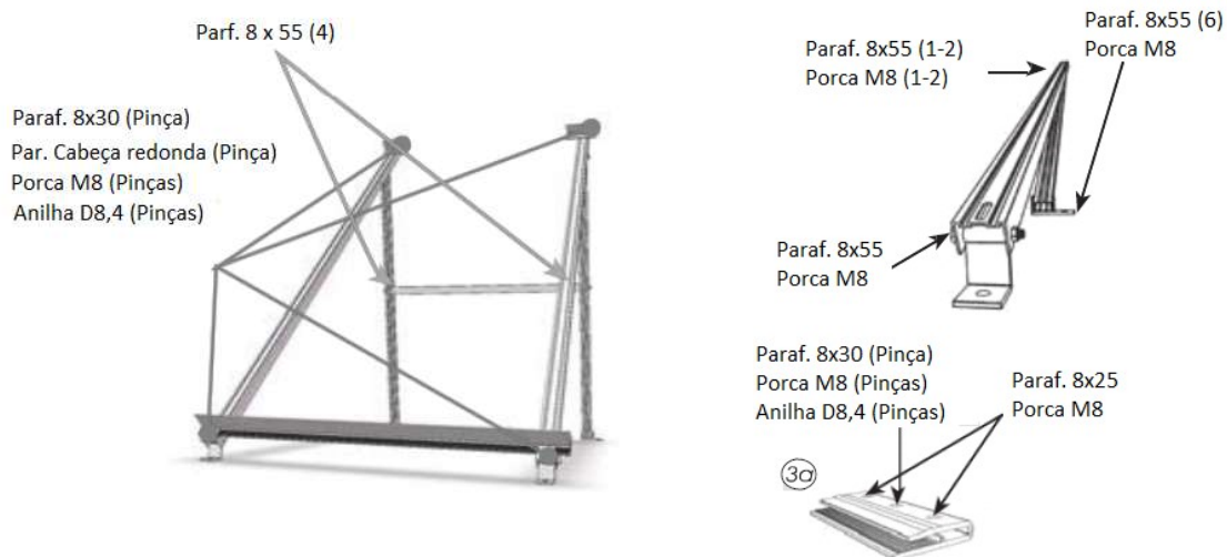
Figura 3. Fixações do suporte.
