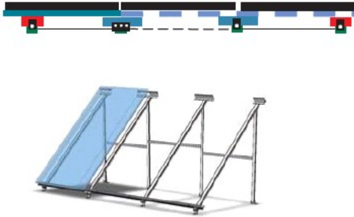
Figura 9. Esquema de 3 coletores e diagrama de distâncias entre pontos de fixação.
